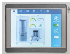
Компьютерная панель управления с 15-дюймовым сенсорным экраном
